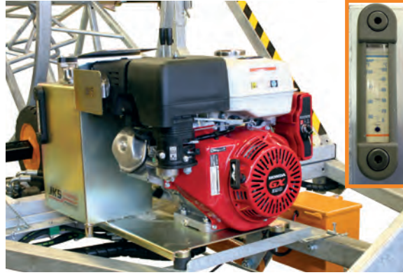
Hydraulikoneikko + 9hp Honda polttomoottori, joka voidaan varustaa sähköstartilla
